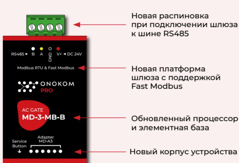
Добавлена кнопка светодиод с индикацией работы и состояния шлюза
