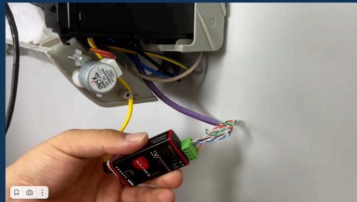
С одной стороны в разъем. С другой - подключаем к шине RS485
