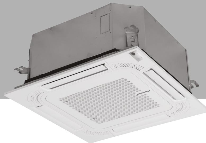
Кассетные внутренние блоки подходят для потолков с ячейкой 600x600, высота всего 215 мм. Независимое регулирование жалюзи (с комплектного ИК-пульта или опционального проводного пульта). Режим компенсации высоты помещения. Круговое распределение воздуха. Встроенная помпа с подъемом до 1 200 мм. Фильтр удобно расположен, его легко менять и мыть.
