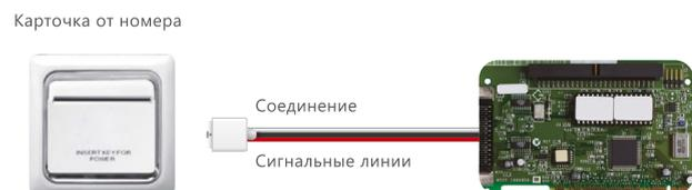
На плате управления предусмотрен разъем, к которому через сигнальный кабель возможно подключение системы контроля доступа гостиничного номера.
