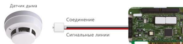
На плате управления предусмотрен разъем, к которому через сигнальный кабель возможно подключение системы противопожарной безопасности.
