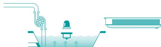
**c** Когда уровень воды поднимается до этого уровня, переключатель касается аварийного сигнала, воздуховод перестает работать.
