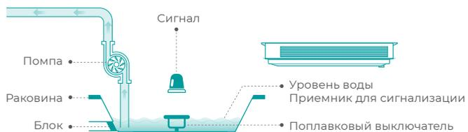
**b** Когда насос перестает работать и уровень воды повышается, исходя из конструкции большого сливного поддона, машина продолжает работать в обычном режиме.
