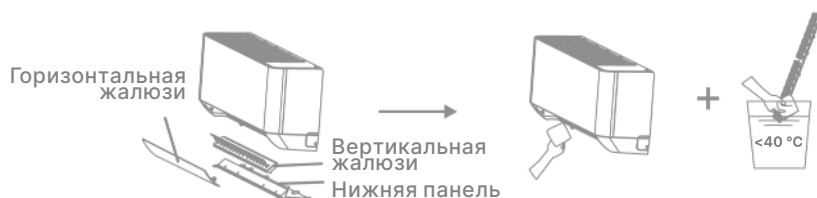
Рисунок 12 — Очистка внутренних полостей внутреннего блока
