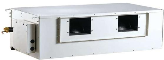
Канальные высоконапорные блоки RMS-IN...-D1/V2FA со 100% притоком свежего воздуха – это внутренние блоки с возможностью беспрерывной обработки воздуха, поступающего с улицы. В блоках применяется более мощный теплообменник в сравнении с обычными кондиционерами, который позволяет более эффективно утилизировать высоко-потенциальное тепло из уличного воздуха в теплое время года. Блоки являются отличной альтернативой использованию классических систем приточной вентиляции воздуха.
