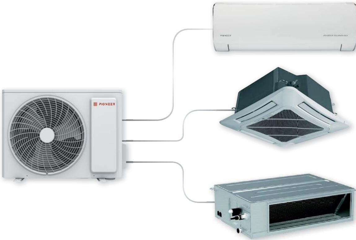
Мультисплит-системы Pioneer – это кондиционеры с универсальными наружными блоками, к которым можно подключить от 2 до 5 внутренних блоков настенного, кассетного или канального типов. Диапазон холодопроизводительности предлагаемых внутренних блоков – от 2,35 до 7,1 кВт, а суммарная производительность системы может варьироваться от 4 до 20 кВт.
