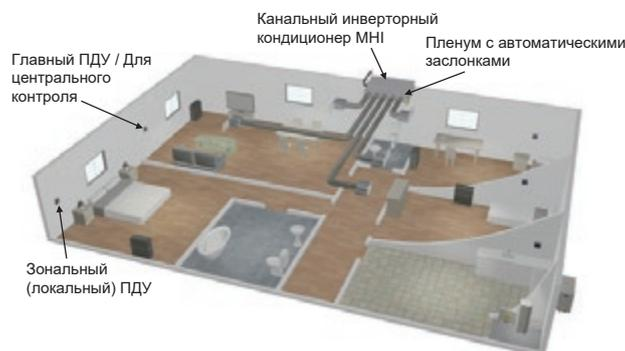
Данная опция специально сконструирована и адаптирована под каналные блоки MHI серий FDUM и FDU (кроме мощности 200/250) и имеет несколько типоразмеров рамы. Количество заслонок варьируется от 2 до 8 шт., а их диаметр может быть 150 и 200 мм. Конструкция сделана по типу «всё в одном» – включает в себя механические и электрические компоненты для регулировки расхода воздуха, а также блок управления.
