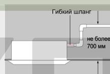
Дренаж можно поднимать на 700 мм от уровня потолка. Это обеспечивает большую свободу при прокладке дренажа. Гибкий шланг длиной 260 мм в качестве стандартного аксессуара упрощает монтаж.
