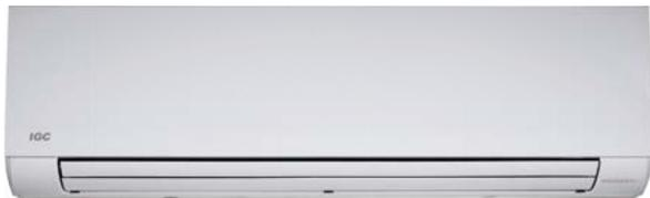
Двухтрубные настенные фанкойлы IGC представлены моделями производительностью от 2.63 до 5 кВт. Поставляются в комплекте с воздушным противопылевым воздушным фильтром класса G2, беспроводным пультом управления, дренажным поддоном. Трехходовой клапан встроен в корпус фанкойла.
