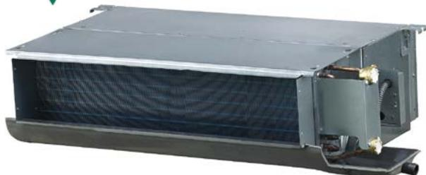
Двухтрубные каналные фанкойлы IGC представлены моделями производительностью от 2 до 12.5 кВт, с двух- или трехрядными теплообменниками и внешним статическим давлением 30 или 50 Па. Поставляются в комплекте с дренажным поддоном, разработанным с учетом подключения 3-ходового клапана к фанкойлу (клапан в комплект не входит) и быстросъемным воздушным противопылевым фильтром класса G2. Корпус выполнен из стали с гальваническим покрытием, хорошо противостоящим коррозии.
