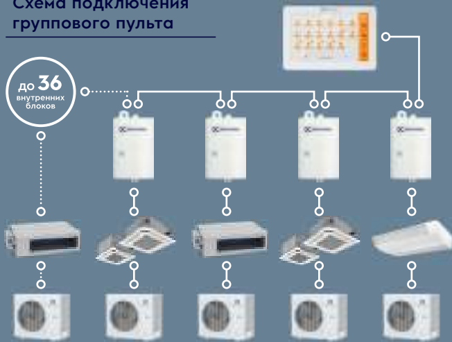
Схема управления кондиционирования в BMS
