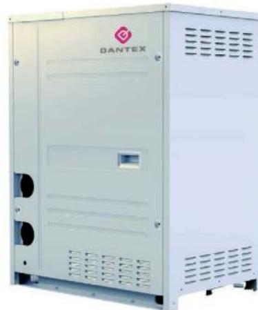
Серия MVS DC-W наружных блоков VRF с жидкостным охлаждением конденсатора представлена моделями производительностью 25,2 и 33,5 кВт. Предельная мощность модуля из 3-х блоков – 100,5 кВт (36 л.с.). В наружном блоке осуществляется теплообмен между теплоносителем, который подается по системе трубопроводов, аналогичной применяемой в системе чиллер-фанкойл, и хладагентом, поступающим по стандартным фреоновым магистралям.
