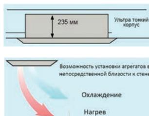
Простая интеграция в системы кондиционирования в соответствии с индивидуальными особенностями помещений. (Сверхтонкий корпус позволяет производить установку агрегата даже в условиях ограниченного пространства).
