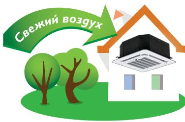
Кассетный кондиционер позволяет подавать воздух с улицы. Чтобы увеличить приток свежего воздуха, в воздуховод можно установить вентилятор (мощность не более 200 Вт).
